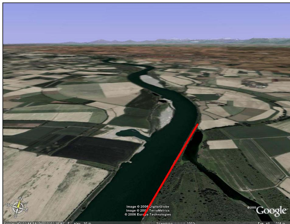
**Figura 19** Fronte in erosione in dx idraulica e ambito di cava, in rosso la porzione di pennello da abbassare, maggio 2005 (fonte Google Earth)
