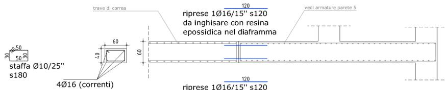
SEZIONE B-B TRAVE DI CORREA-MURO
